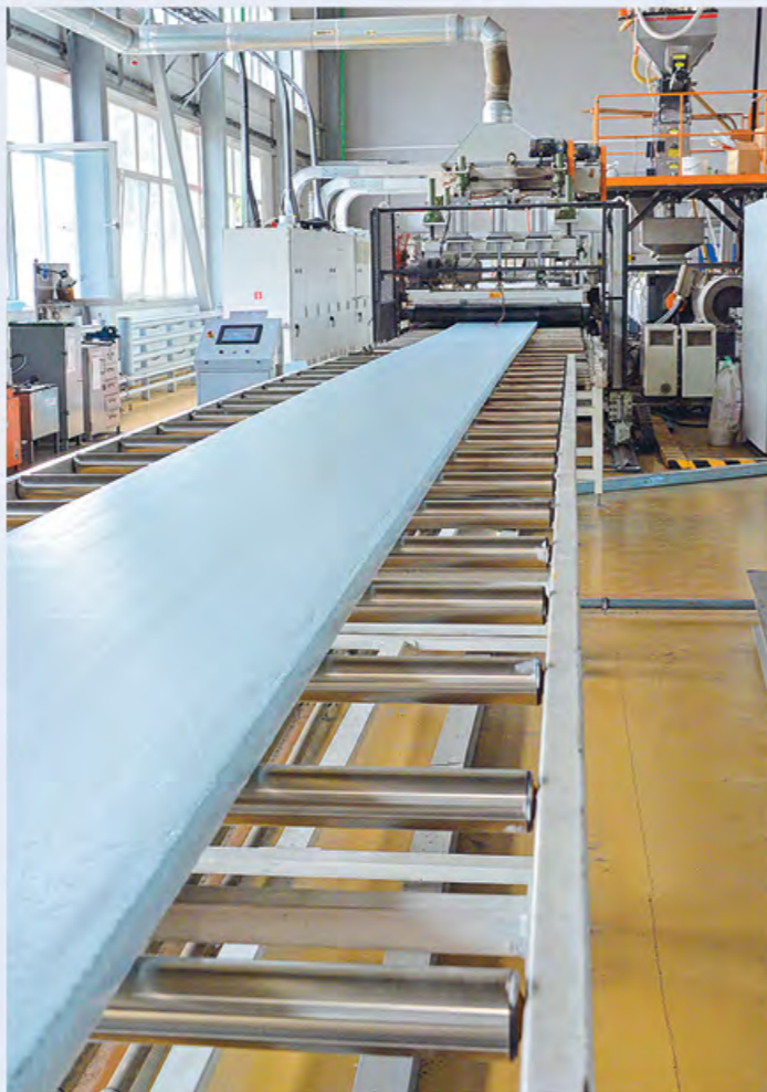
Выход полотна плиты «БАТЭПЛЕКС» из экструдера марки Sunwell Global.
