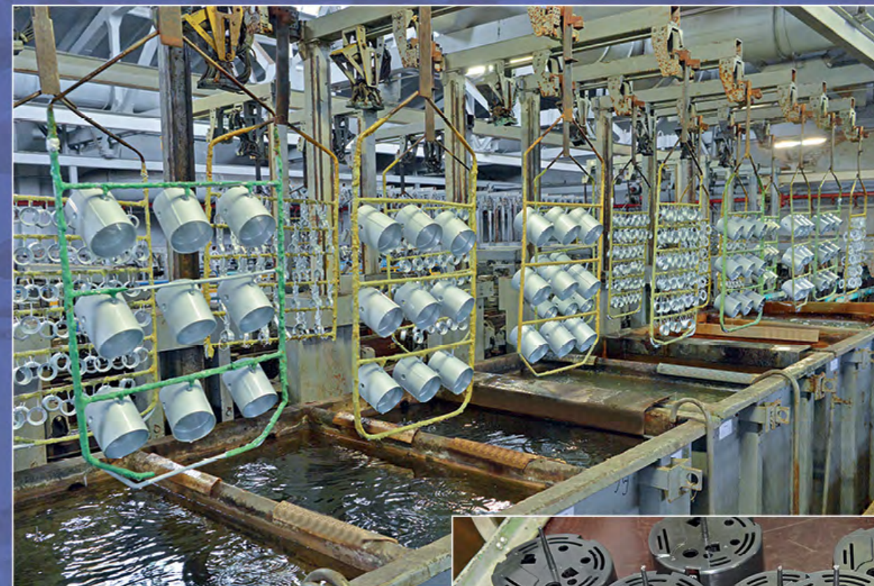
Гальваническая оцинковка деталей стартера на автоматической линии VAS.
