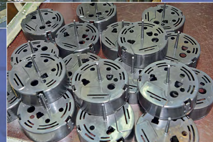
Защитный кожух генератора 3232.3771 640-40 после проведения операции литья.
