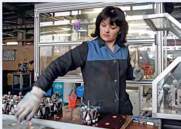
Балансировка ротора генератора. 2008 г.
