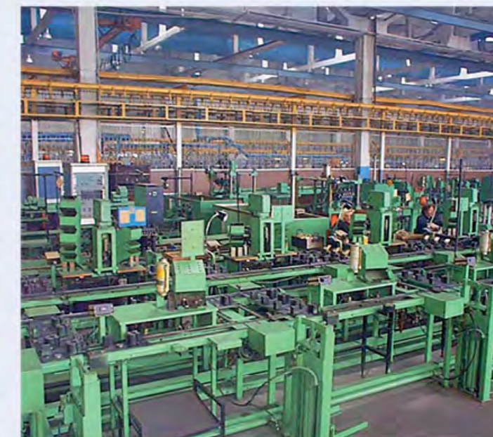
Комплексно-механизированная линия сборки стартеров «Баконь» (Венгрия). 1987 г.
