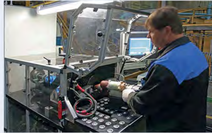
Участок контроля характеристик стартеров 142-й группы на линии сборки цеха № 15.
