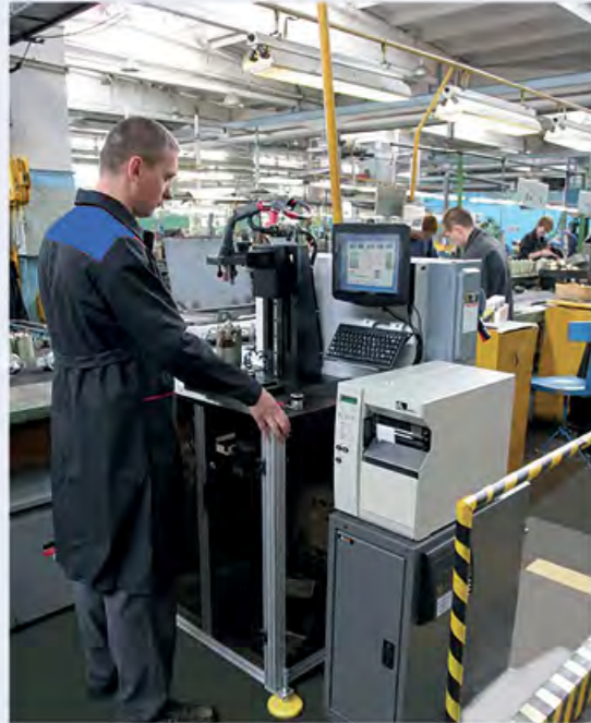
Участок контроля характеристик стартеров на линии сборки цеха № 6.
