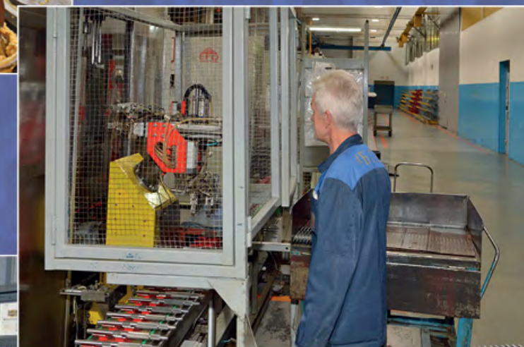
Наладчик станков и манипуляторов с ПУ А.Е. Кондратович выполняет опробование установки ТВЧ после наладки.
