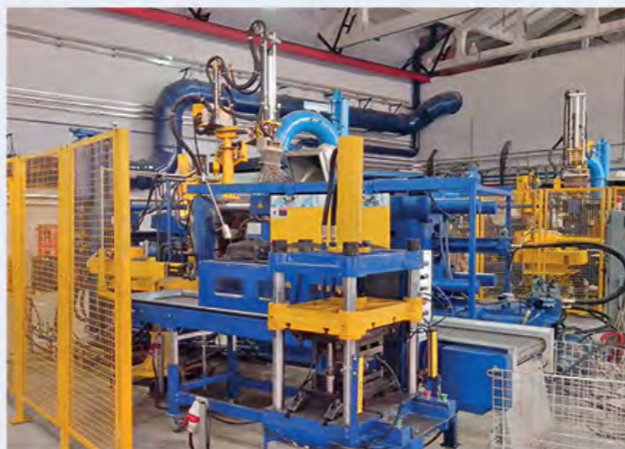
Автоматизированный литейной комплекс на базе машины для литья под высоким давлением модели DM400 с охлаждающим конвейером и обрубным прессом.
