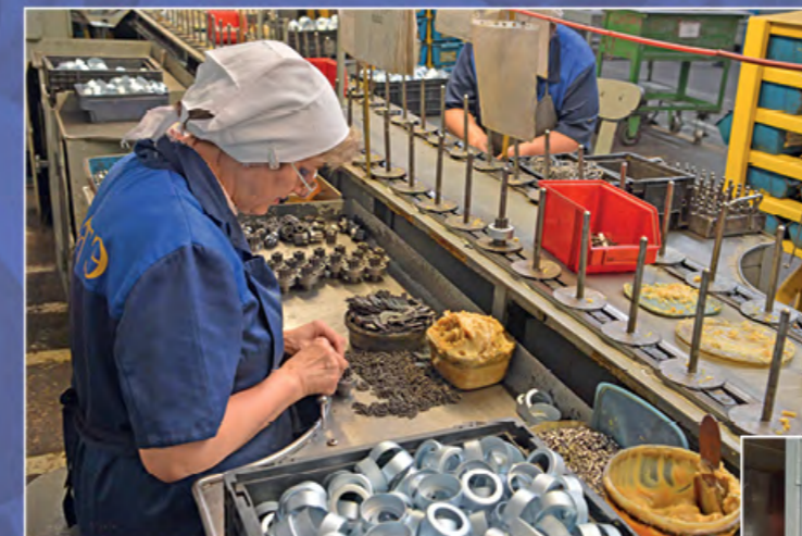
Слесарь МСР Л.В. Мальцева выполняет сборку муфты привода 5112.610.
