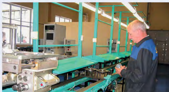
Наладка линии сборки стартеров в новом сборочном цехе. 2008 г.
